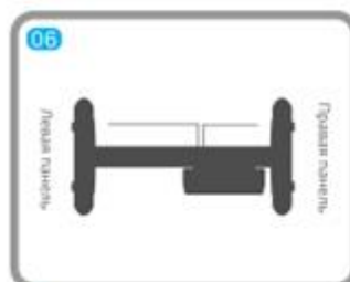
06 Подключите кабели от электронного блока к обеим панелям.
